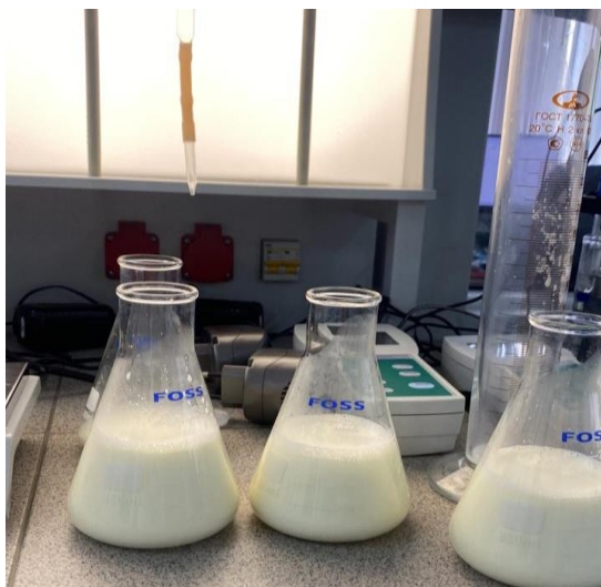
Рис. 3 – Определение кислотности проб молока с помощью pH-метра
