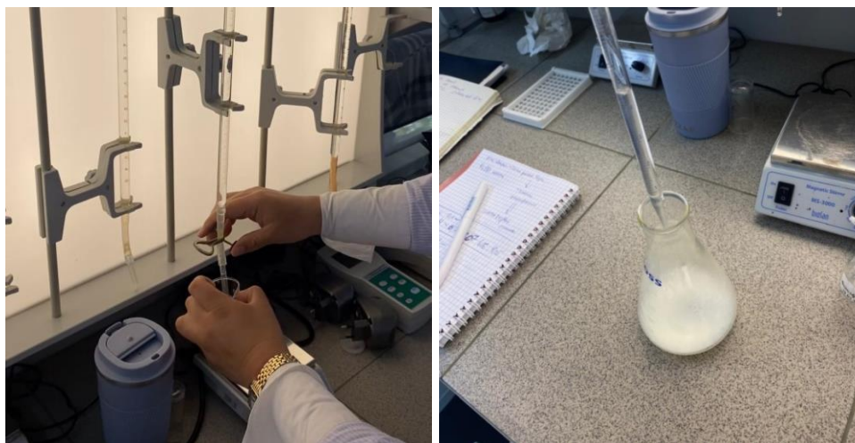
Рис. 4 а, б – Определение титруемой кислотности проб молока
